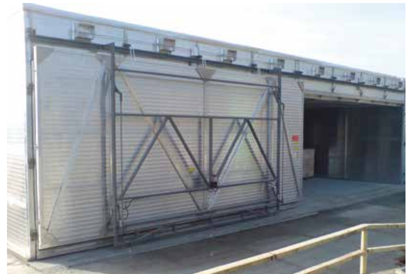
Suszarnie typu SK z w pełni zautomatyzowanym procesem suszenia są komorowe, wolnostojące, o konstrukcji modułowej umożliwiającej budowę komór w układzie szeregowym.
