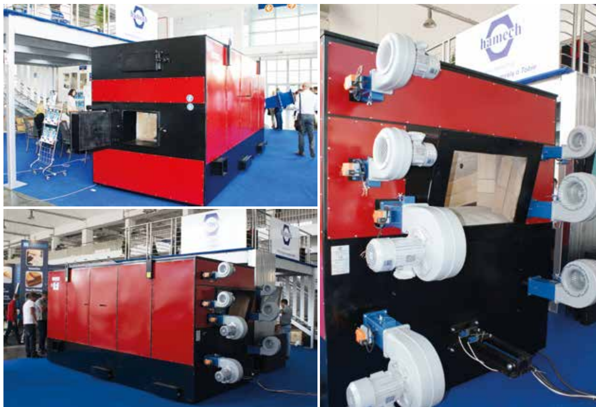
1+2+3 Największym zainteresowaniem zwiedzających cieszył się kocioł, za który otrzymaliśmy Złoty Medal MTP, czyli ZGH 3000 z ruchomym rusztem i systemem ogrzewania powietrza pierwotnego oraz wtórnego. Fot. Piotr Kmiecik
