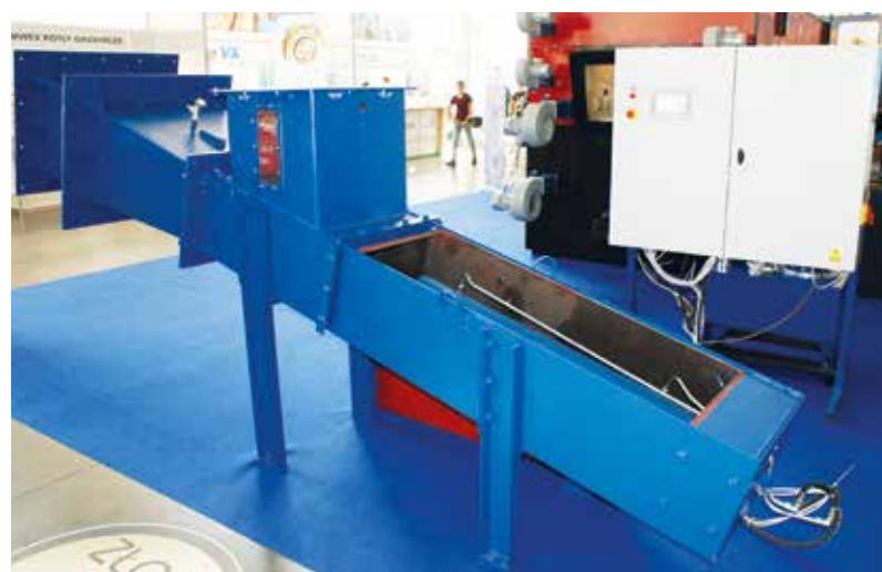
1+2+3 Największym zainteresowaniem zwiedzających cieszył się kocioł, za który otrzymaliśmy Złoty Medal MTP, czyli ZGH 3000 z ruchomym rusztem i systemem ogrzewania powietrza pierwotnego oraz wtórnego. Fot. Piotr Kmiecik
